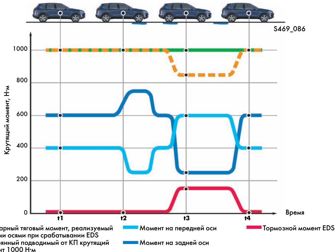
В этом примере Touareg проезжает небольшой обледенелый участок (состояния  $t_2$  и  $t_3$ ) при постоянном крутящем моменте, поступающем от силового агрегата. Предположим, что граница срыва в пробуксовку\* составляет 250 Н·м на ось. Общий крутящий момент составляет ( $t_1$  и  $t_4$ ) 1000 Н·м.
