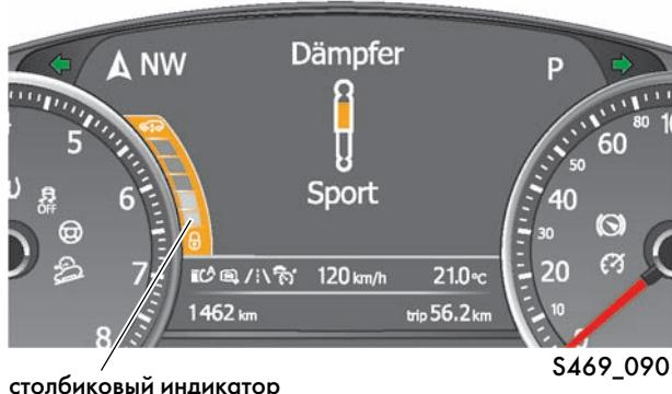
Установленный уровень дорожного просвета отображается на центральном дисплее в комбинации приборов с помощью столбикового индикатора.
