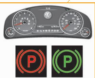
**Контрольная лампа электромеханического стояночного тормоза K213**
