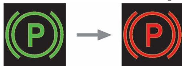
При переключении на электромеханический стояночный тормоз цвет контрольной лампы электромеханического стояночного тормоза K213 в комбинации приборов изменяется с зелёного на красный.
