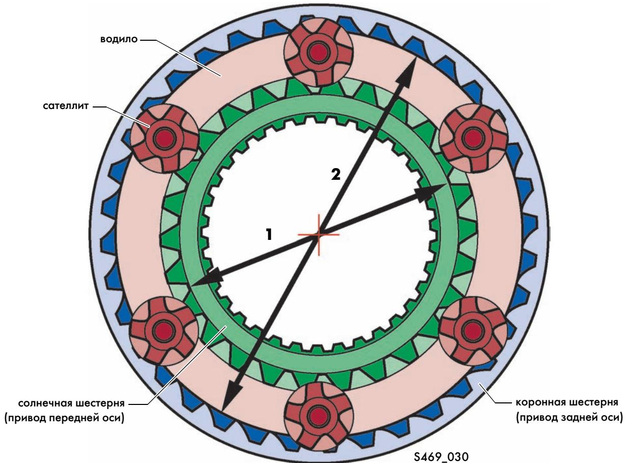
Базовый выходной момент раздаточной коробки распределяется по осям неодинаково (ассиметрично), а именно в соотношении 40:60 (передняя ось к задней). Это достигается благодаря различным диаметрам солнечной (привод передней оси) и коронной (привод задней оси) шестерён.
