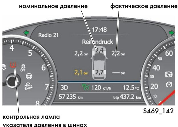
При требующем внимания отклонении фактического давления от номинального в комбинации приборов загорается контрольная лампа указателя давления в шинах. При этом статус предупреждения дополнительно подтверждается текстовым сообщением, а на дисплей в комбинации приборов выводится схематическое изображение автомобиля с указанием фактического давления в отдельных шинах.
