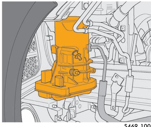
Электрический насос усилителя рулевого управления установлен на консоли на арке переднего левого колеса, под фарой.
