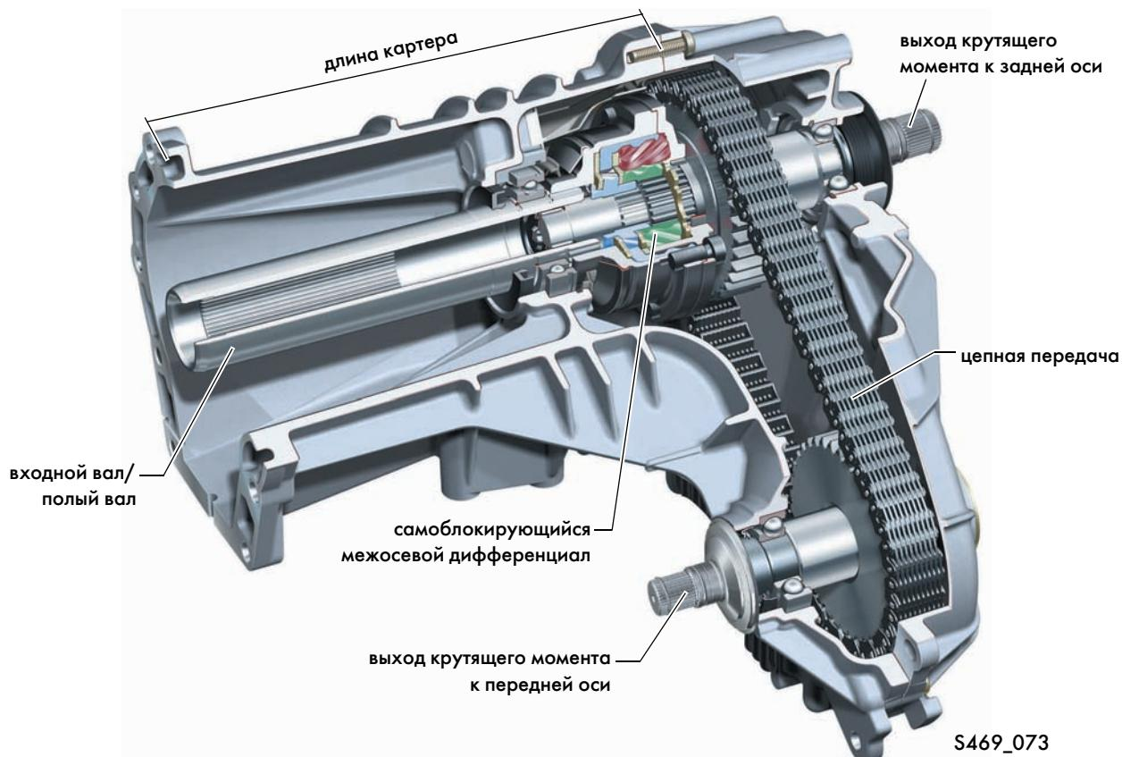
Раздаточная коробка крепится непосредственно к фланцу АКП. Различная длина картера компенсирует разную конструктивную длину силового агрегата.
