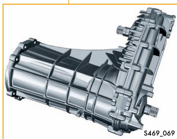
Раздаточная коробка 0BU устанавливается в базовой комплектации (4MOTION). Конструктивно коробка представляет собой самоблокирующийся межосевой дифференциал, который распределяет крутящий момент между осями в зависимости от сцепления колёс передней и задней оси с дорогой и выравнивает скорости вращения осей, не допуская пробуксовывания одной из них.
