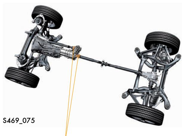
Валы привода осей у Touareg изменены. С целью снижения массы они выполнены со шлицевым соединением. Шлицевое соединение запирается стопорным кольцом, установленным на выходном вале раздаточной коробки (0BV/0BU).
