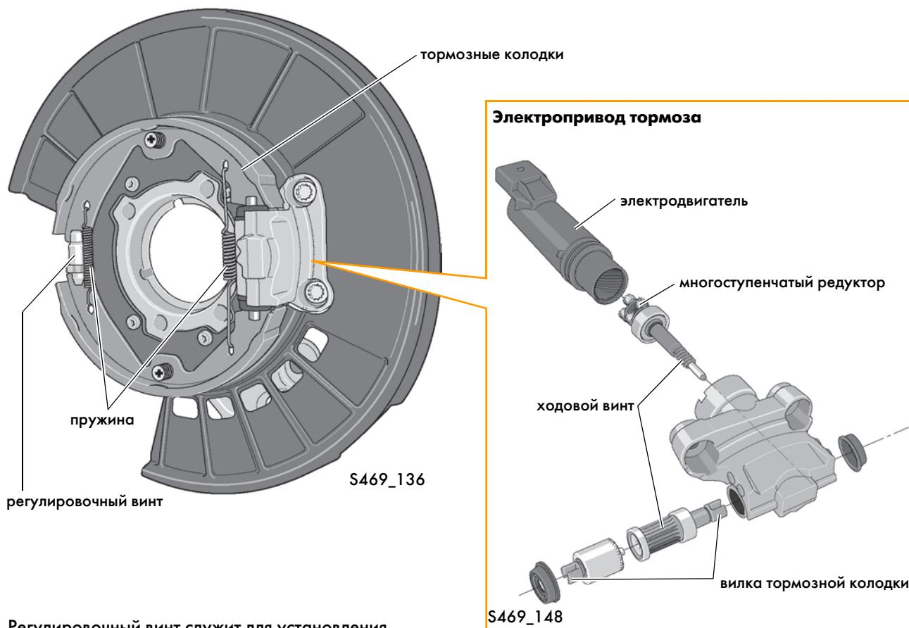
Регулировочный винт служит для установления заданного зазора между тормозным барабаном и тормозными колодками.
