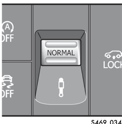
С помощью поворотного переключателя можно выбрать один из трёх вариантов жёсткости подвески:
