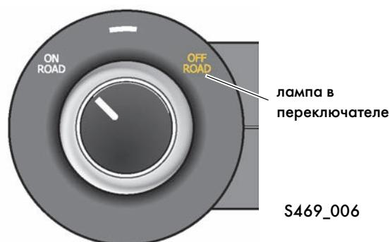
Когда автомобиль находится в режиме OFF ROAD, в переключателе загорается соответствующая контрольная лампа.
