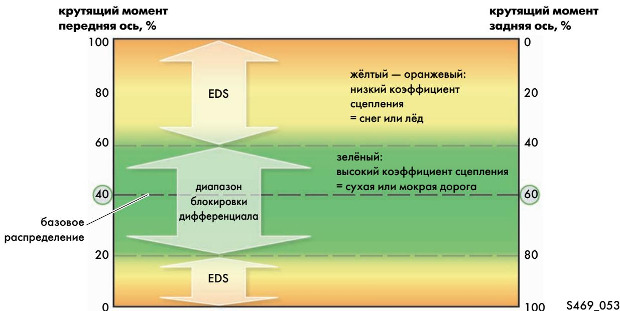
В дополнение к асимметричному базовому распределению 40:60 в дифференциале создаётся момент трения (блокирующий момент), пропорциональный крутящему моменту.
