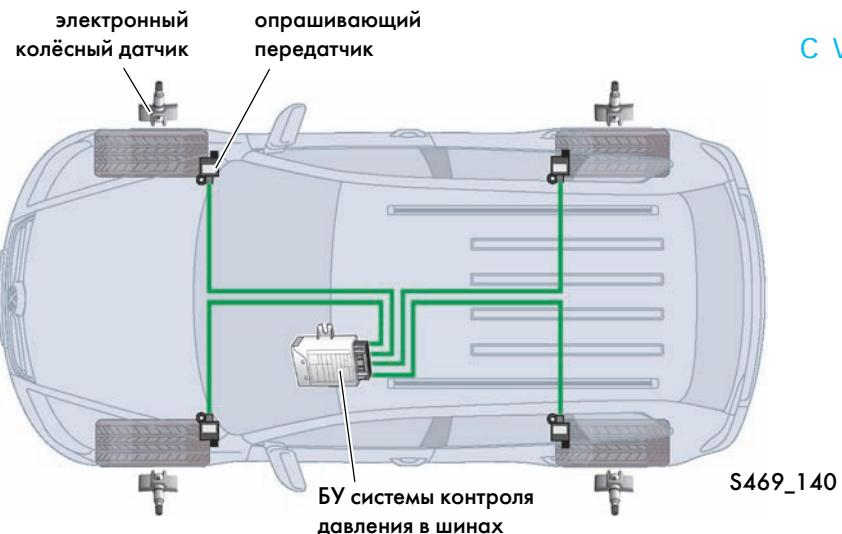
С помощью передатчиков в колёсных нишах блок управления может целенаправленно опросить каждый из колёсных датчиков низкочастотным радиосигналом LF (Low Frequency), который является командой на отправку ответного сообщения с данными. Это сообщение с данными принимается и анализируется непосредственно блоком управления, который может определить, с какого именно места (справа/слева спереди/сзади) было передано каждое сообщение.
