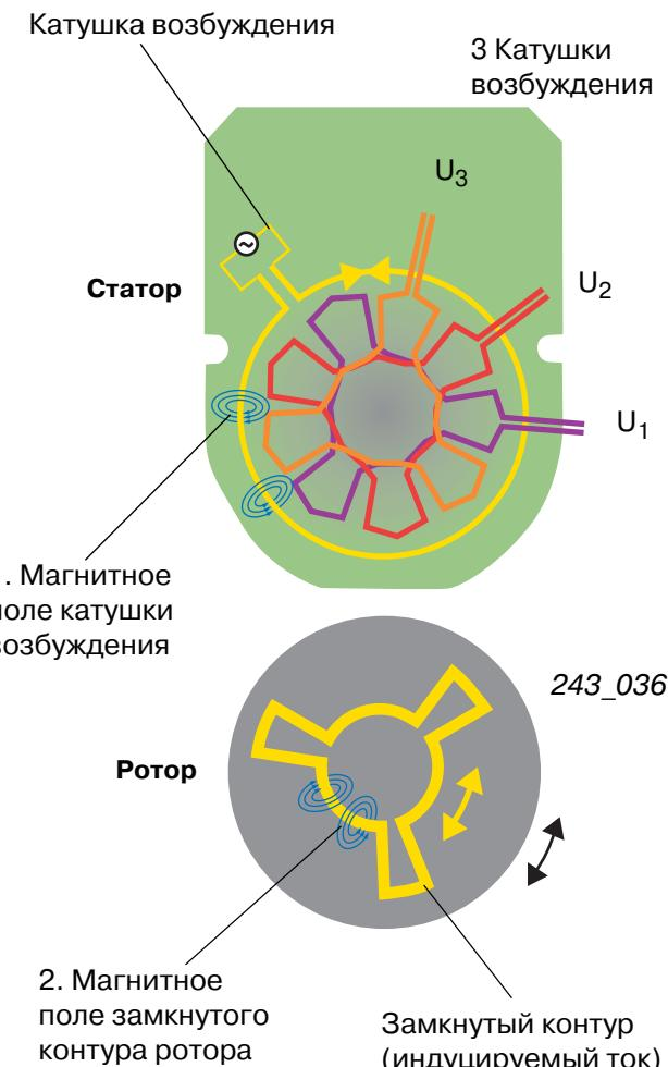
**Амплитуды напряжений в зависимости от взаимного положения ротора и приемной катушки (пример для одного из положений ротора)**
