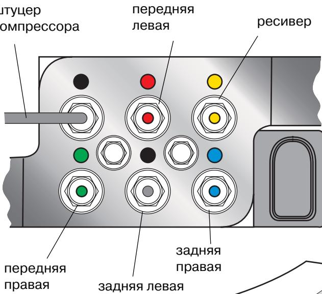
4 клапана пневматических упругих элементов N148, N149, N150, N151 и клапан ресивера N311 собраны в едином корпусе, который называют блоком клапанов. Это нормально закрытые (закрыты в обесточенном состоянии) двухходовые двухпозиционные клапаны (2/2 — два штуцера и два положения). Сила давления со стороны пневматических упругих элементов/ресивера действует на закрытие клапанов.
